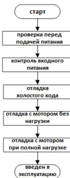
Схема 15. Схема подготовки к вводу в эксплуатацию
