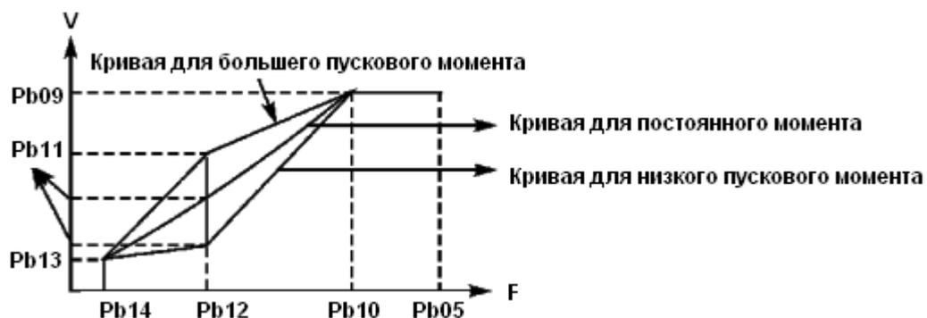
F1.09: V/F-кривая: максимальное напряжение. Максимальное напряжение должно быть установлено в соответствии с моделью двигателя. В большинстве случаев это номинальное напряжение двигателя, но когда двигатель находится в пределах 30 м от контроллера, следует установить немного большее значение.
