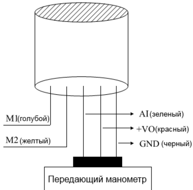
Схема подключения передающего манометра
