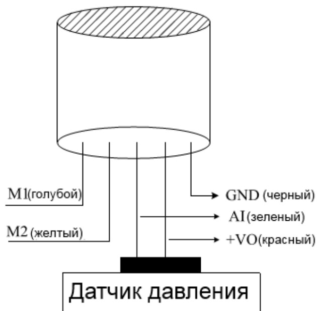
Схема подключения двухпроводного датчика давления
