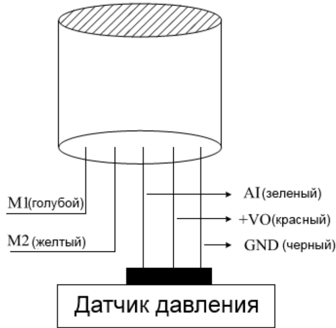
Схема подключения трехпроводного датчика давления
