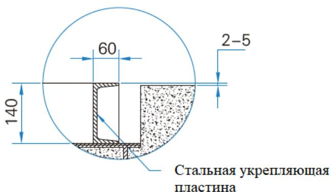
Рисунок 12. Схема фундамента для монтажа
